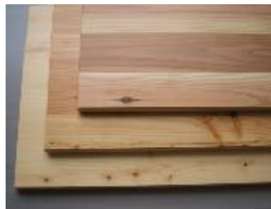
写真 樹脂コーティング処理材 (上/スギ材、中/カラマツ材、下/ヒノキ材)
